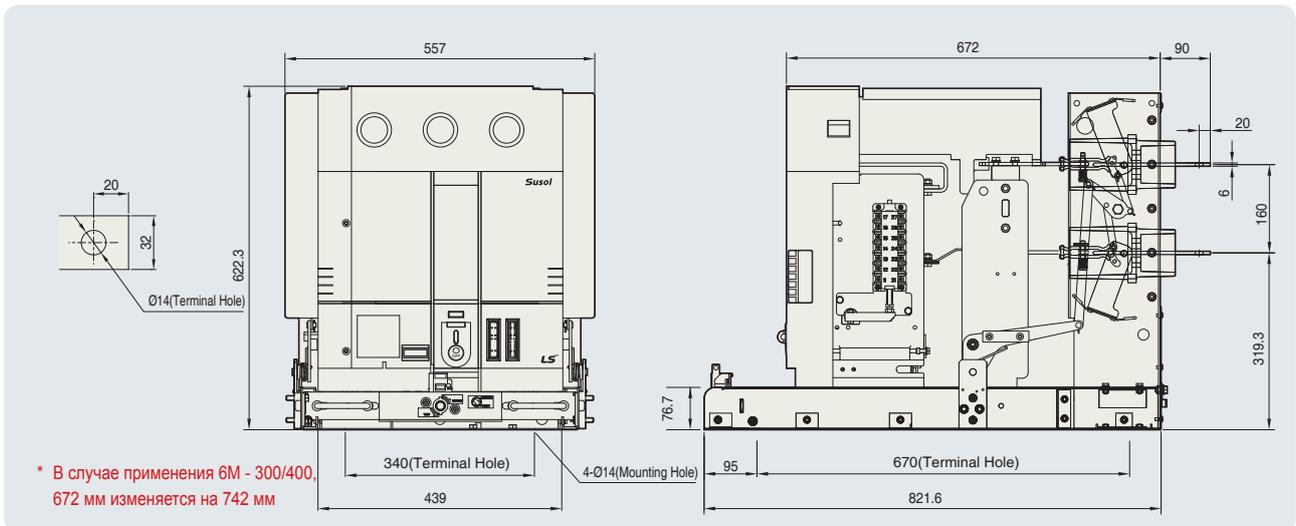
**Корзина H-Class (Исполнение с предохранителями (выдвижное исполнение))**
