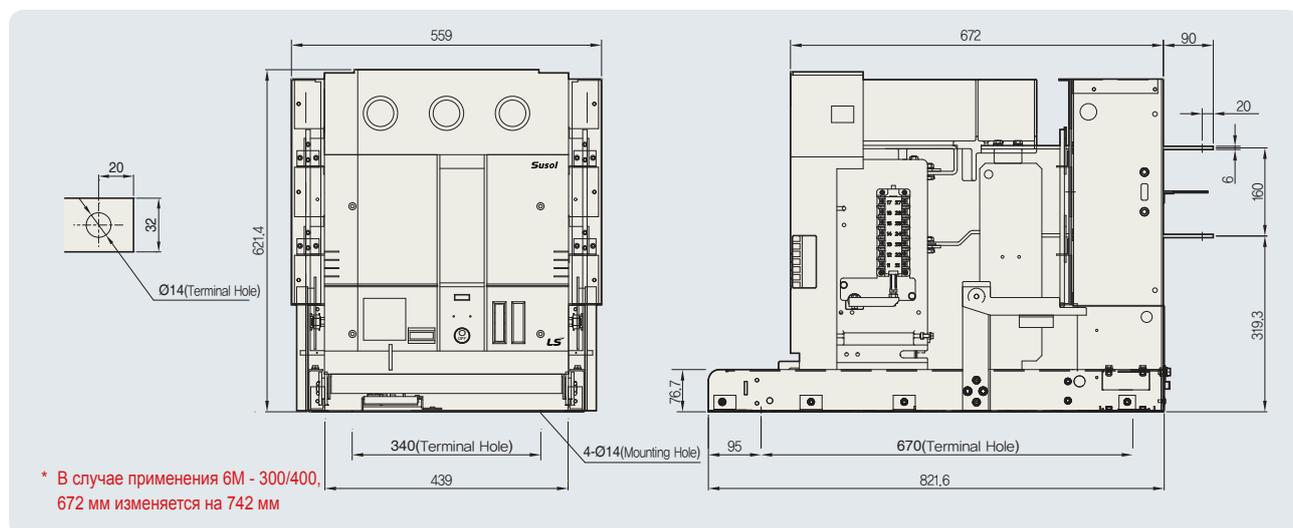
**Корзина G-Class (Исполнение с предохранителями (стандартное исполнение))** [Единица измерения: мм]
