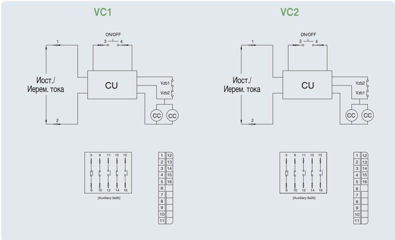
двустабильный приводной механизм\_CTD(Иост. тока 110 В~220 В): Стационарное исполнение
