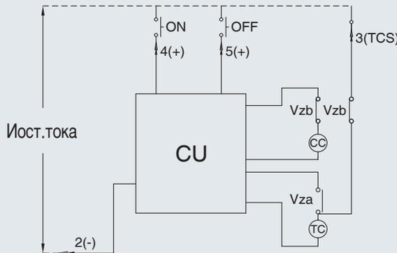
Включение вакуумного контактора производится замыканием цепи на зажимах 4(+) и 2(-)
