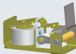
Приводной механизм с защелкой
