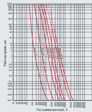
3.6kV, 7.2kV Характеристика токоограничения
