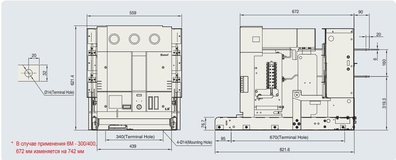
**Корзина M-Class (Исполнение с предохранителями (стандартное исполнение))**
