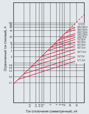
Тип M (предохранители для защиты электродвигателей)
