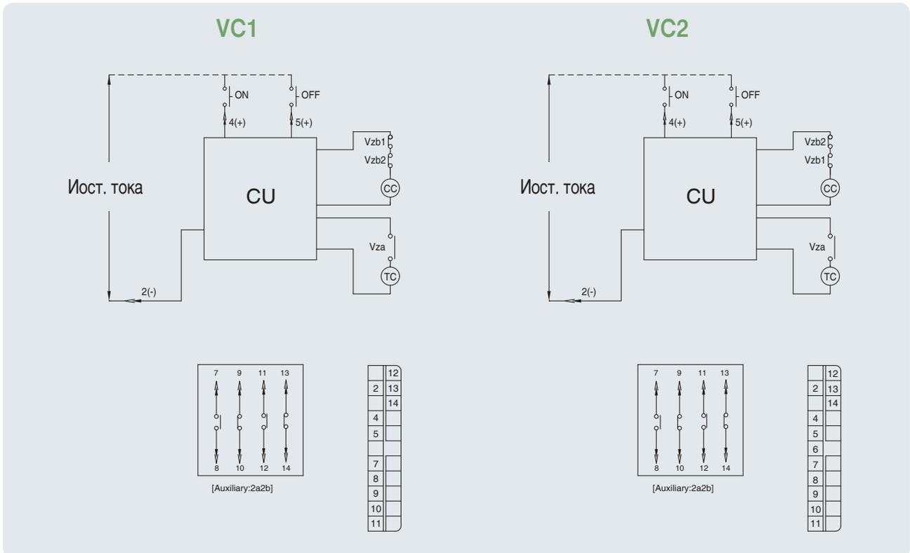
двустабильный приводной механизм\_CTD(Иерем. тока 110 В~220 В): Стационарное исполнение
